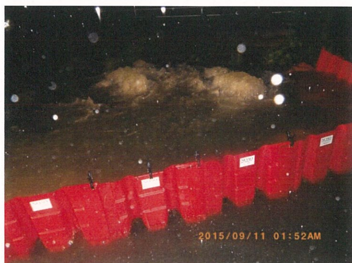
人孔より激しく溢水するも、BOXWALLにより堤防背面には漏水せず。
